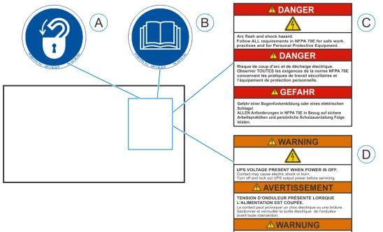
Auch bei ausgeschalteten Hauptschalter unter Spannung. Bei Kontakt elektrischer Schock oder Verbrennungen möglich. Ausschalten und Abstecken der Spannungszufuhr bevor Service durchgefühlt wird.
