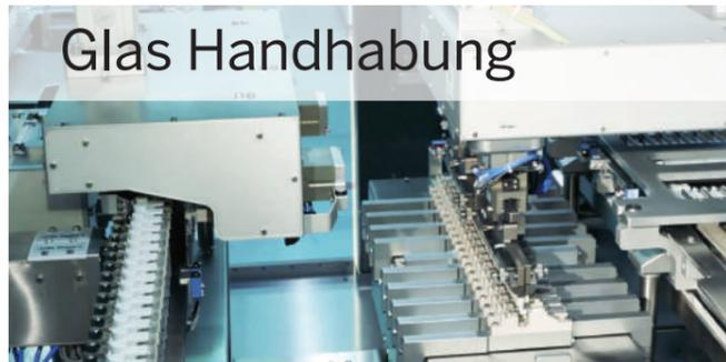
Handling von Glaskörpern, vorgefüllte Spritzen (PFS), Vials etc., inklusive Inspektionssystem und anderen Optionen wie das Etikettieren von Produkten. Ebenso wie das Handling von Rondo Trays und Tub/Nest Kombinationen.
