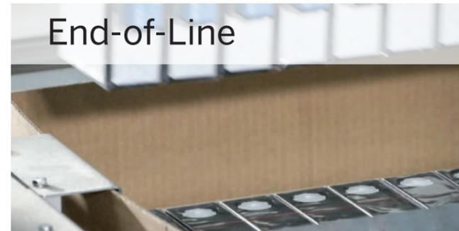
Be- und Entladen von Versandkartons, Handling und Gruppierung von einzelnen Faltschachteln in Versandkartons. Optional Verschließen mit Klebestreifen oder Straffbänderolieren von Paletten sowie viele weitere Anwendungen.
